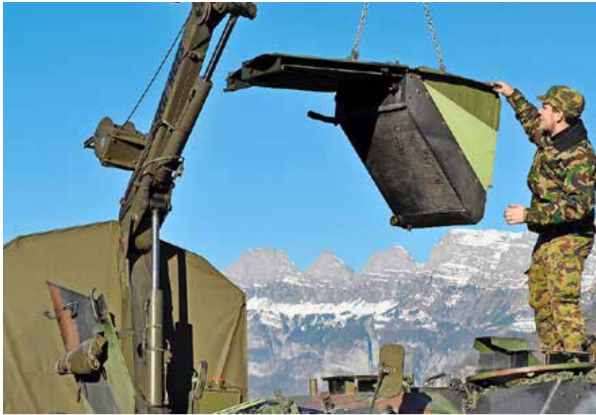
Vorführung bei herrlichem Wetter und Blick zu den Churfürsten: Die ganze Kühlgruppe, mit Kühler und Lüftung, lässt sich ausbauen.
